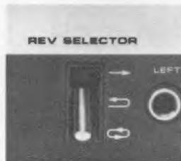
*Dauer-Reverse. In Stellung  $\circlearrowright$  des Reverse-Selectors erfolgt die dauernde Wiedergabe beider Cassettenseiten A und B. Aufnahmen dagegen können nur einmal für die Seiten A und B erfolgen.*
