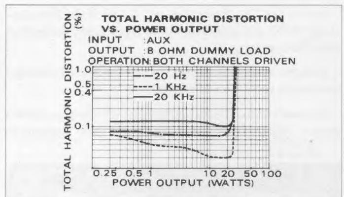
Klirrfaktor (Total Harmonic Distortion) in Abhängigkeit zur Ausgangsleistung (Power Output) gemessen an 8 Ω.
