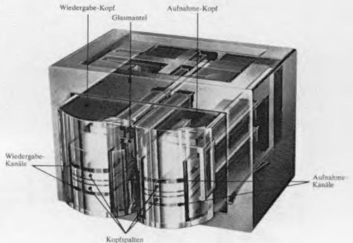
Schon bei der Abweichung von wenigen Bruchteilen eines Grades entsteht eine verminderte Höhenwiedergabe und schlechtere Stereo-Kanaltrennung.
