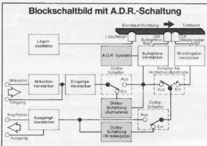
Kompensiert wird dadurch allerdings nur ein Teil der Verzerrungen, weshalb die Ingenieure von Akai das A.D.R.-System entwickelten (Automatic Distortion Reduction System). Es verändert die Aufnahme-Entzerrkennlinie, so daß in jedem Augenblick die jeweils günstigste Entzerrung erreicht wird. Eine vorzeitige Sättigung und die folgende Selbstausslöschung werden vermieden.
